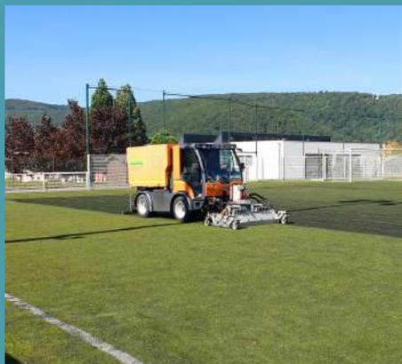
Nettoyage hydraulique du terrain synthétique
